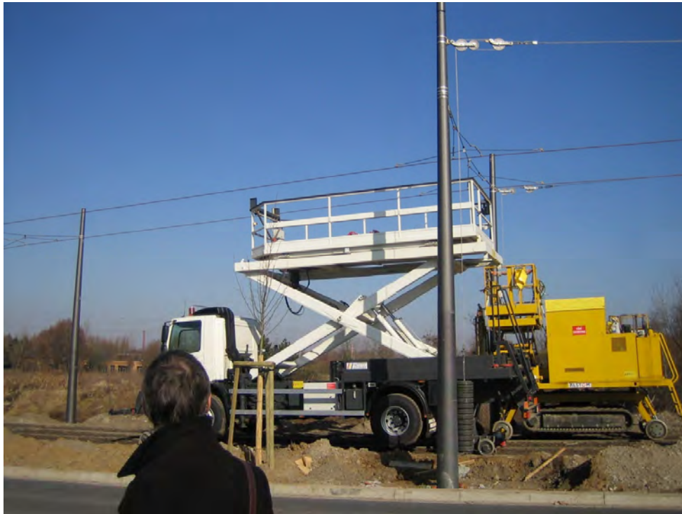
Figure 2 : Photo d'un camion rail/route (en blanc) avec nacelle de grande dimension
